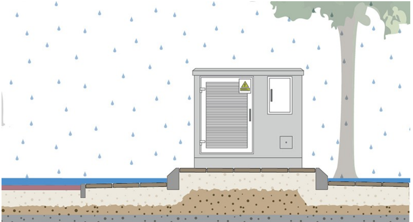
Schematische doorsnede van een rainproof nutsvoorziening. ©Atelier GROENBLAUW
