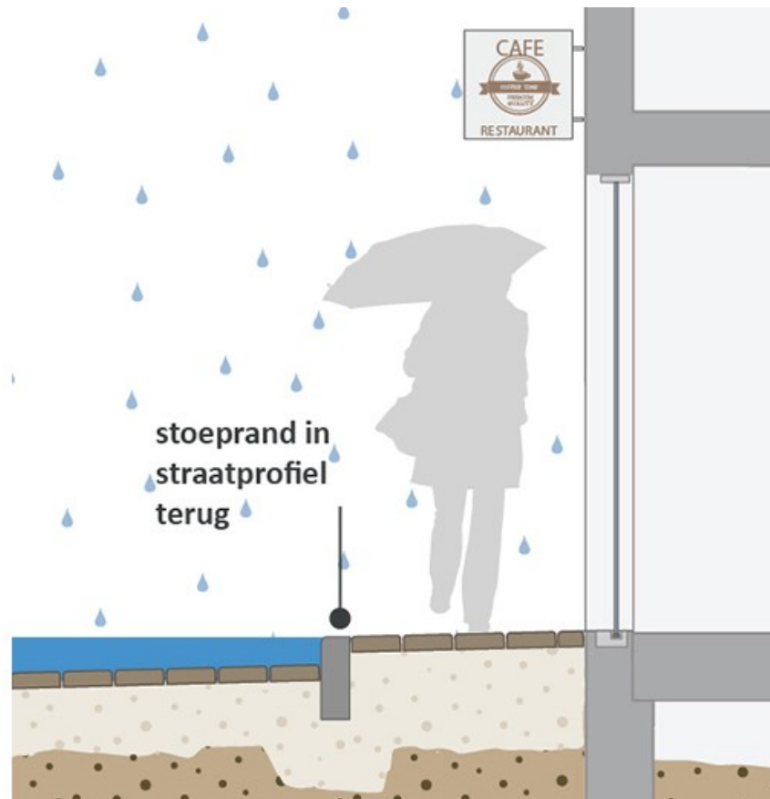
Schematische doorsnede van een teruggebracht stoep in het straatprofiel.
